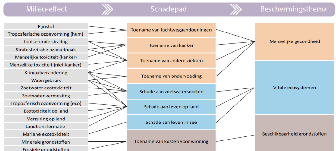
Figuur 5.4: Impact categorieën in de ReCiPe2016-methode. Bron: Huijbregts et al. (2016), vertaling KiM
